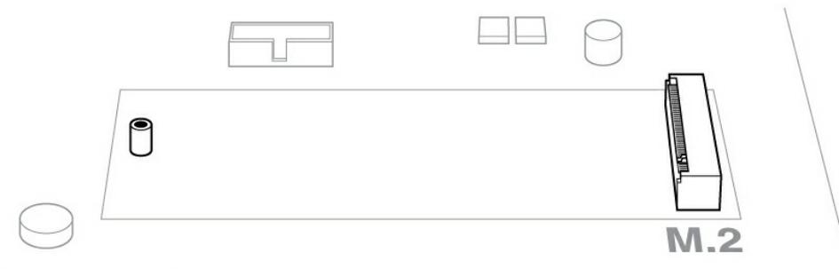
注 - マザーボードによっては、デフォルトでM.2\_PADのスペースにパッドが取り付けられている場合があります。SSDにぴったりフィットさせるために、このパッドは取り外すことができます。
