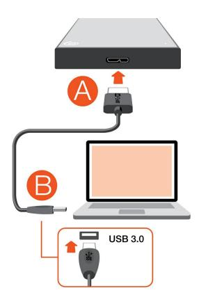
**1** お使いの Seagate デバイスは、コンピュータの USB-C ポートに接続できます。USB-C ポートは USB 3.0 以上に対応している必要があります。USB Micro-B to USB-C ケーブルはこのデバイスには同梱されていません。
