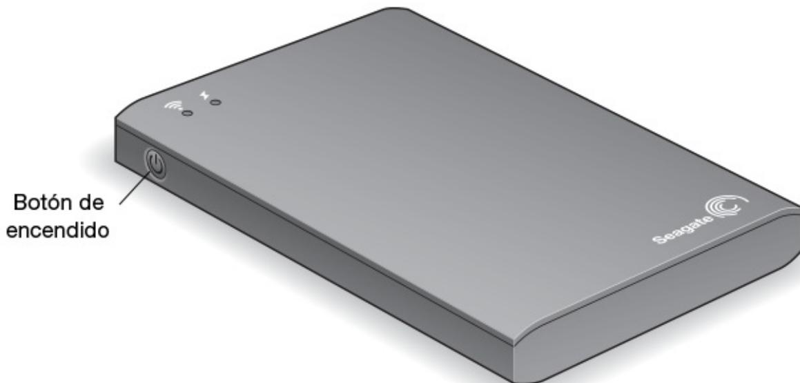
El indicador LED de Wi-Fi parpadea cuando se enciende el dispositivo. Cuando la luz de Wi-Fi es de color azul fijo, el dispositivo dispone de conexión Wi-Fi y está listo para aceptar otras conexiones de dispositivos.
